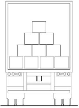
A diagrama ilustra a distribuição correta de carga dentro de uma carroceria. A carga é representada por uma pirâmide de caixas, com uma caixa no topo, duas no segundo andar, três no terceiro e quatro no quarto andar. A carroceria é mostrada com seus eixos e rodas, e a carga está centralizada e equilibrada. |
