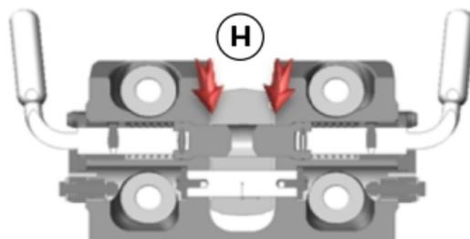
Opcionalmente, é oferecido o modelo com elementos de desgaste poliméricos, dispensa a aplicação de graxa entre o pino esférico (E) e a Ponteira Esférica (D), uma vez que é equipado com elementos poliméricos de desgaste nessa interface, sendo uma calota polimérica (K), montada na Ponteira Esférica (D), e o inserto polimérico (L), montado no parafuso de ajuste (H), conforme ilustrado na figura abaixo.
