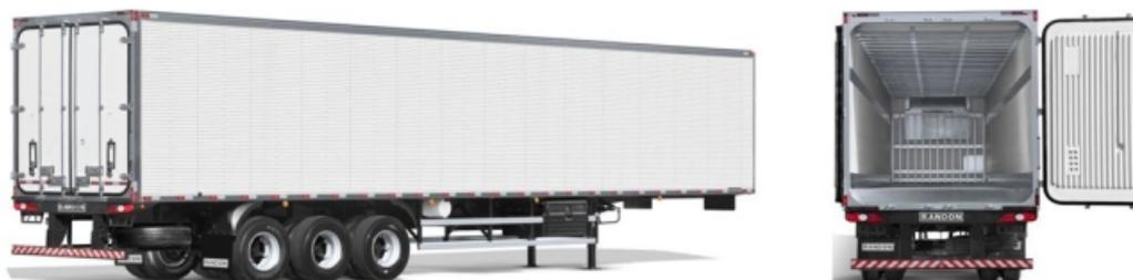
Implemento para o transporte de produtos perecíveis, em ambiente com temperatura controlada. Revestido internamente com fibra de vidro e isolamento térmico em poliuretano. Ideal para o transporte de carnes congeladas e resfriadas, penduradas em gancheiras e também pode transportar cargas paletizadas.
