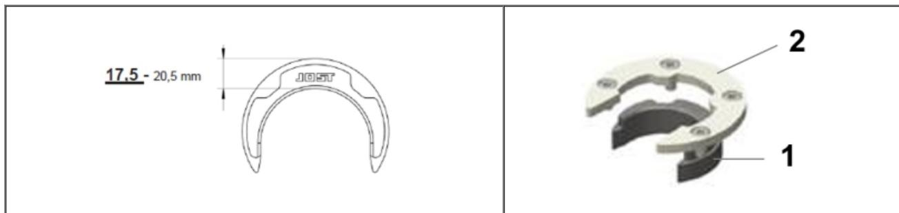
As placas poliméricas de desgaste (ind. 1) fixadas no bloco da Quinta-roda (ind. 3) devem ser verificadas quanto a sinais de desgaste e danos irregulares pelo menos a cada 50.000 km ou seis meses. As placas poliméricas de desgaste (ind. 1) devem ser substituídas quando atingirem o topo dos parafusos de fixação (ind. 2).
