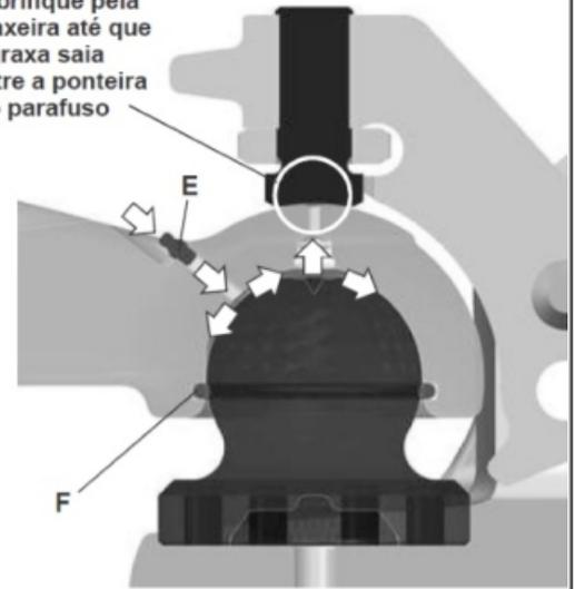
A lubrificação deve ser realizada com a ponteira acoplada e o engate esférico fechado, através da graxeira da ponteira (ind. E). Aplique graxa até que comece a sair entre a ponteira e o parafuso de ajuste, conforme as Revisões Periódicas no Capítulo Manutenções.
