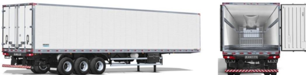
Implemento para o transporte de produtos perecíveis, em ambiente com temperatura controlada. Revestido internamente com fibra de vidro e isolamento térmico em poliuretano, específico para cargas paletizadas.
