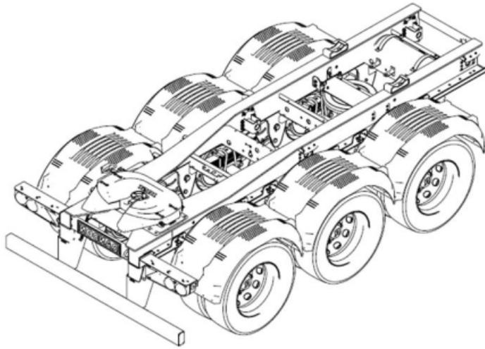
Projetado para operações de carga e descarga do primeiro bitrem da combinação, usando a parte traseira do implemento, devido a possibilidade de realizar o deslizamento da base e caixa de carga do bitrem dianteiro sobre o chassi; a quinta-roda permanece em posição fixa. A movimentação através de tração do cavalo mecânico é caracterizada pelo deslizamento do conjunto base mais a caixa de carga sobre o chassi deslizante, que permanece em posição fixa.
