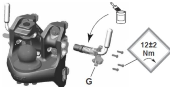
Sempre que realizar a lavagem do semibreoque com jato de água, antes de acoplar a ponteira, lubrifique o pino esférico com graxa EP 2, evitando assim a possibilidade de danificar o O'ring de vedação da ponteira.
