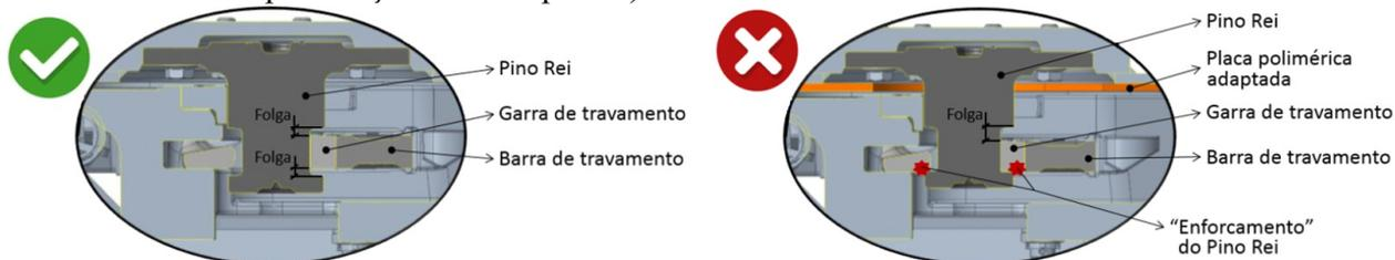
Após a substituição do pino-rei, verificar a folga no sistema de travamento da quinta-roda, como segue:
